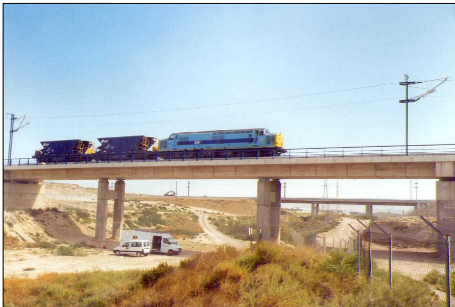
Nº 6.- Prueba de carga estática en vanos nº 1 y nº 2, con una fila de una locomotora y dos tolvas, visto desde el lado derecho de la estructura.
