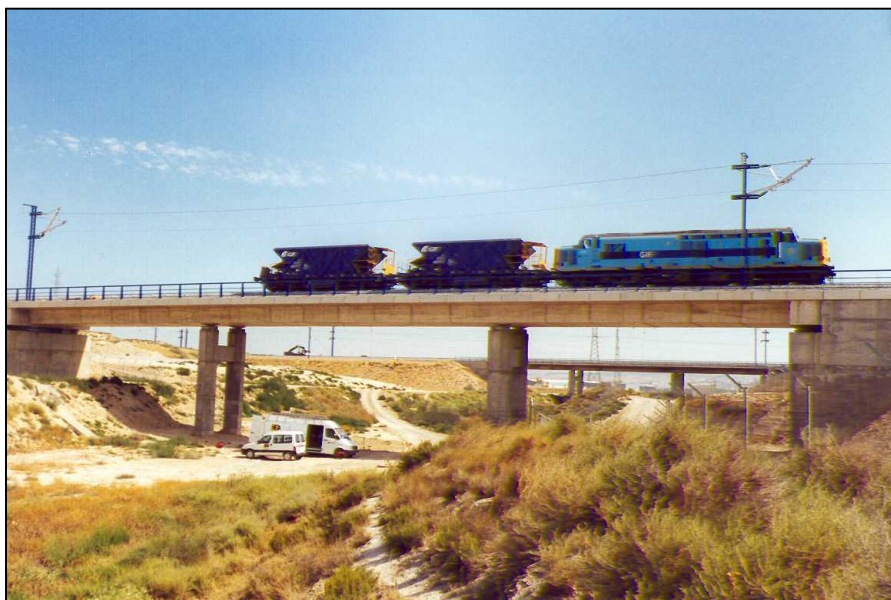
Nº 6.- Prueba de carga estática en vanos nº 1 y nº 2, con una fila de una locomotora y dos tolvas, visto desde el lado derecho de la estructura.
