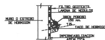
DETALLE DE IMPERMEABILIZACION ESCALA 1/20
