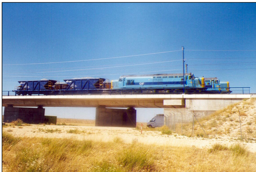
Nº 6.- Prueba de carga estática en vanos nº 3 y nº 4, con dos filas de una locomotora y dos tolvas cada una, visto desde el lado Madrid.
