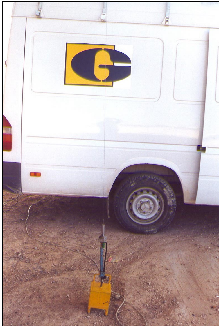
Nº 5.- Instrumentación con LVDT's en centro de luz de vano.
