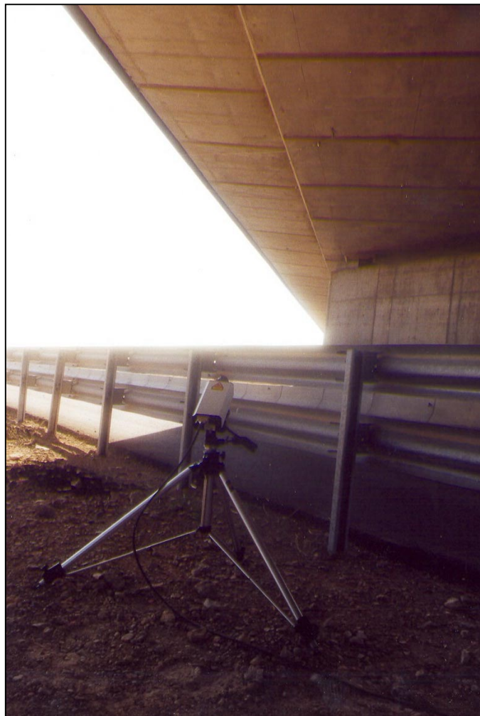
Nº 4.- Equipo óptico utilizado para la medida de flechas en el centro de luz del vano nº 2.
