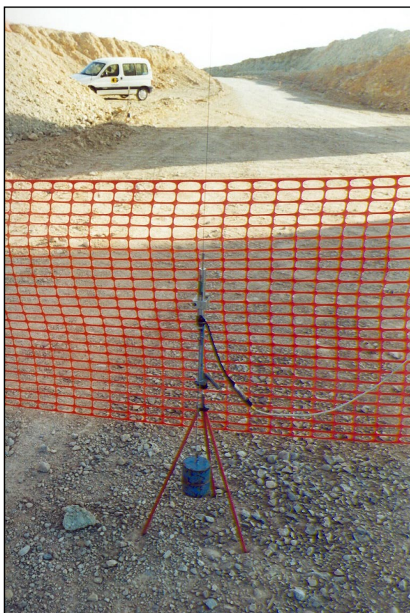
Nº 1.- Instrumentación con LVDT's.
