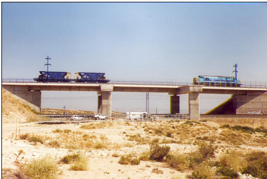
Nº 3.- Prueba de carga estática en vanos nº 1 y nº 3, con dos filas de una locomotora y dos tolvas cada una, visto desde el lado de Zaragoza.
