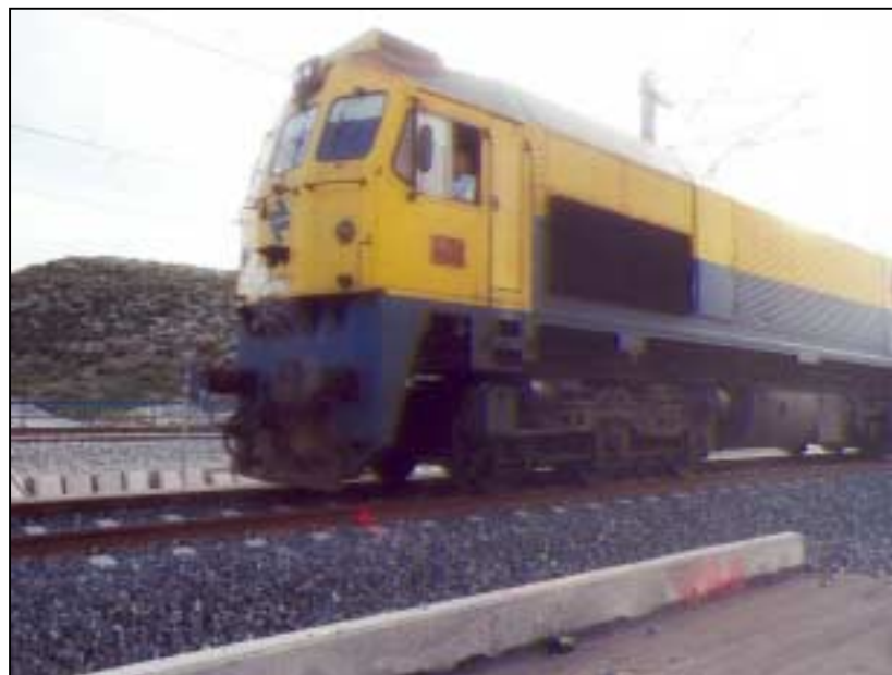
Nº 7. - Realización de la prueba dinámica de frenado.
