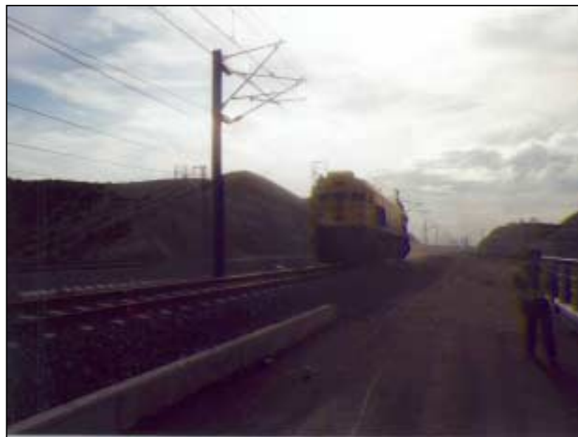
Nº 5.- Realización de la prueba dinámica a 30 Km/h.
