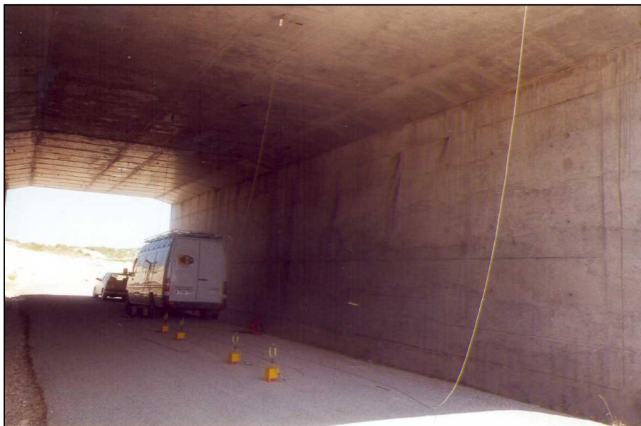
Nº 2.- Colocación de los aparatos de medida.
