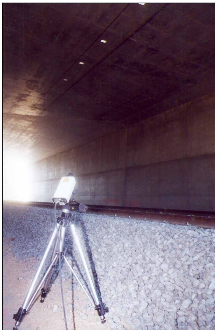
Nº 1.- Medida de descensos verticales mediante sistema óptico POLITEC.
