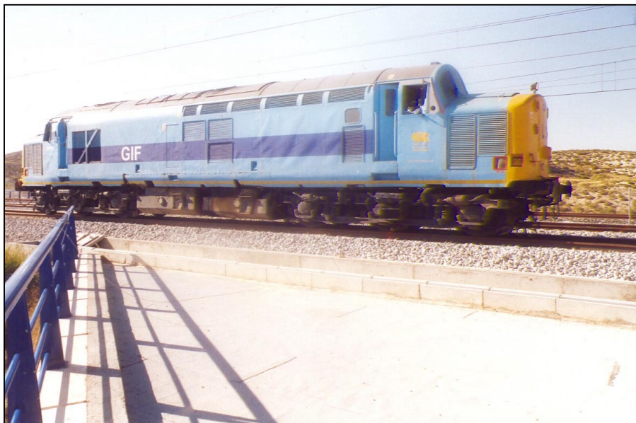
Nº 5.- Realización de la prueba dinámica a 30 Km/h.
