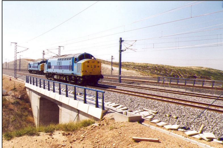
Nº 4.- Realización de las pruebas dinámicas de frenado.
