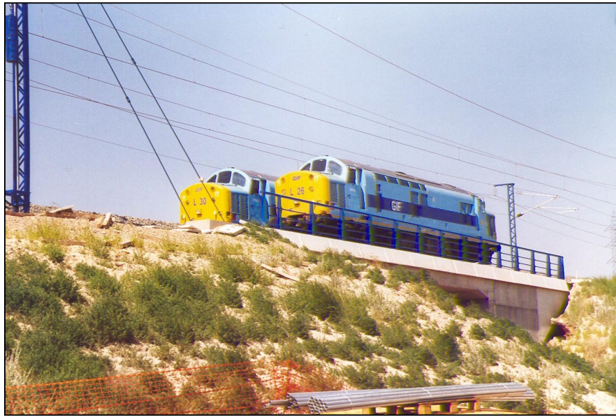
Nº 4.- Posicionamiento de las cargas.
