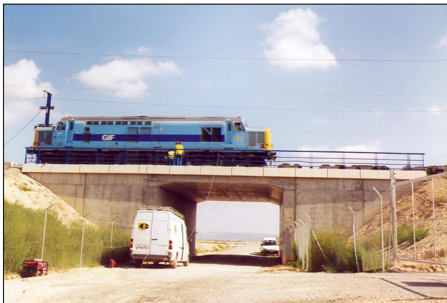
Nº 6. Realización de las pruebas dinámicas de frenado.
