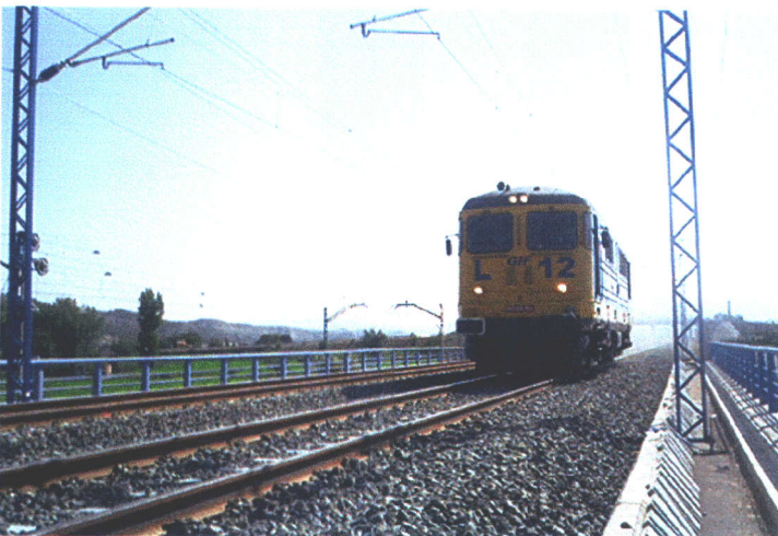
Fotografía N° 12: Prueba dinámica de frenado so- bre el vano 2 del tablero 1.
