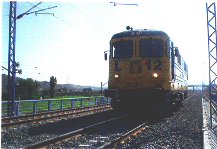
Fotografía N° 10: Prueba dinámica a máxima velocidad sobre el tablero 1.
