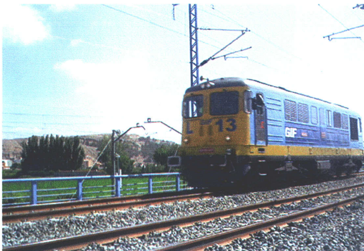
Fotografía N° 13: Prueba dinámica de frenado sobre el vano 2 del tablero 2.
