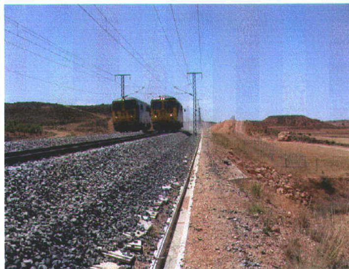
Fotografía N° 6: Prueba dinámica de frenado sobre la estructura.
