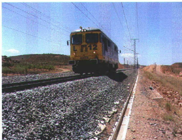
Fotografía N° 5: Ensayo dinámico a 70 Km/h.
