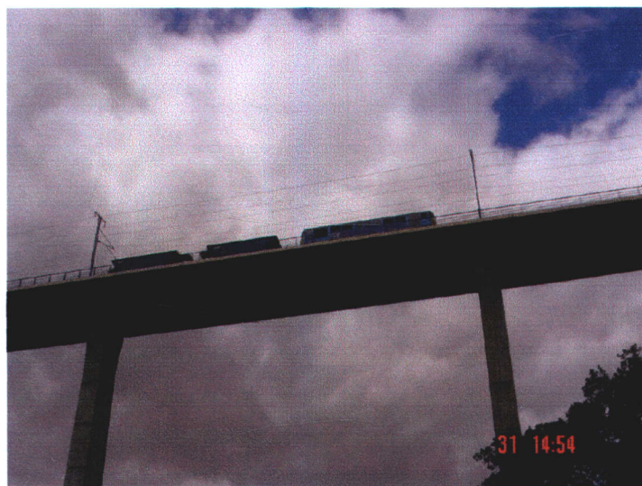
Fotografía N° 5: Ensayo estático 5. Vehículos en Vano 4.
