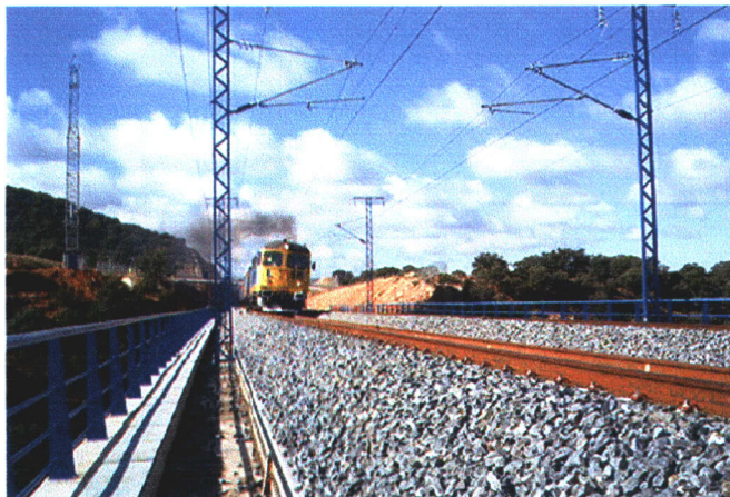
Fotografía N° 10: Ensayo de frenado sobre el vano 3.
