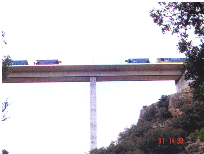
Fotografía N° 4: Ensayo estático 4. Vehículos en Vano 4 y Vano 5.
