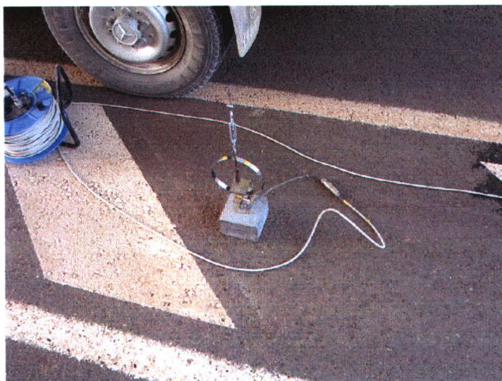
Fotografía N° 13: Detalle del anillo extensométrico.
