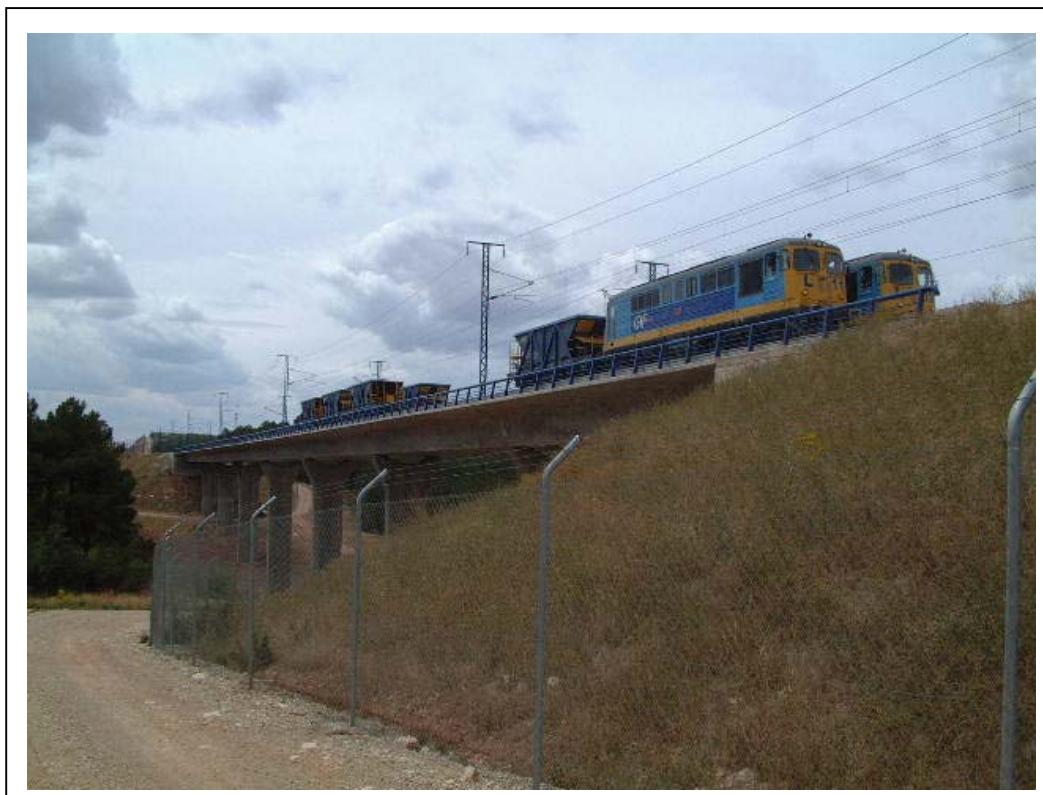
FOTOGRAFÍA 13: Trenes de carga posicionados para la prueba estática 4 cargando los vanos 6 y 8
