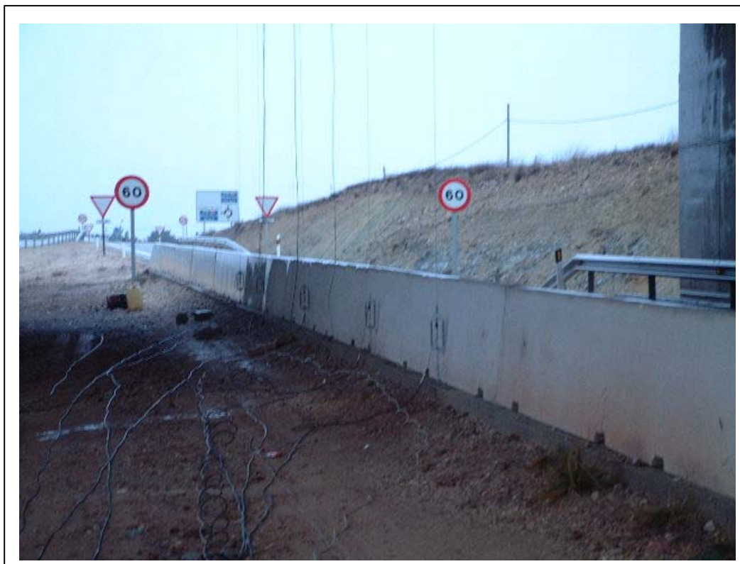
FOTOGRAFÍA 5: Transductores de desplazamiento en el centro del vano 2 anclados al suelo
