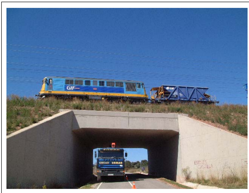
FOTOGRAFÍA 9: Trenes tipo situados para la prueba estática 01
