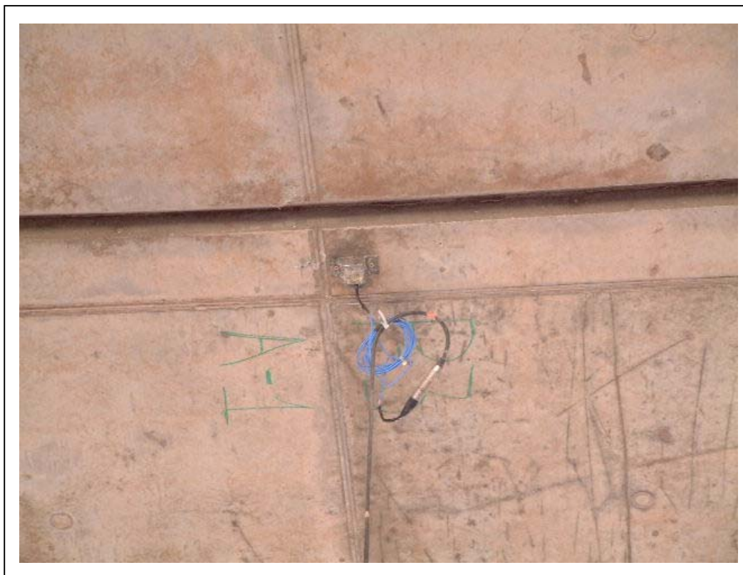
FOTOGRAFÍA 9: Transductor de desplazamiento y acelerómetro para medida de frecuencia propia de vibración en centro de vano
