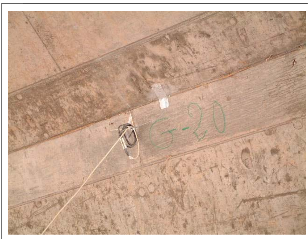
FOTOGRAFÍA 7: Banda extensométrica colocada bajo el carril interior de la vía derecha junto al estribo Zaragoza
