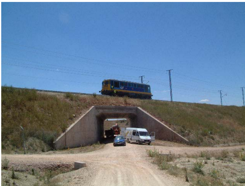
FOTOGRAFÍA 8: Locomotora posicionada para prueba estática
