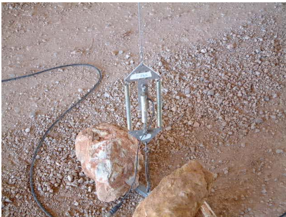
FOTOGRAFÍA 8: Transductor de desplazamiento fijado al suelo
