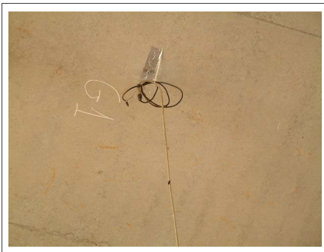
FOTOGRAFÍA 6: Galga bajo carril interior de vía 1
