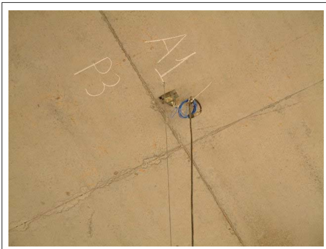
FOTOGRAFÍA 5: flecha y acelerómetro en centro de vano
