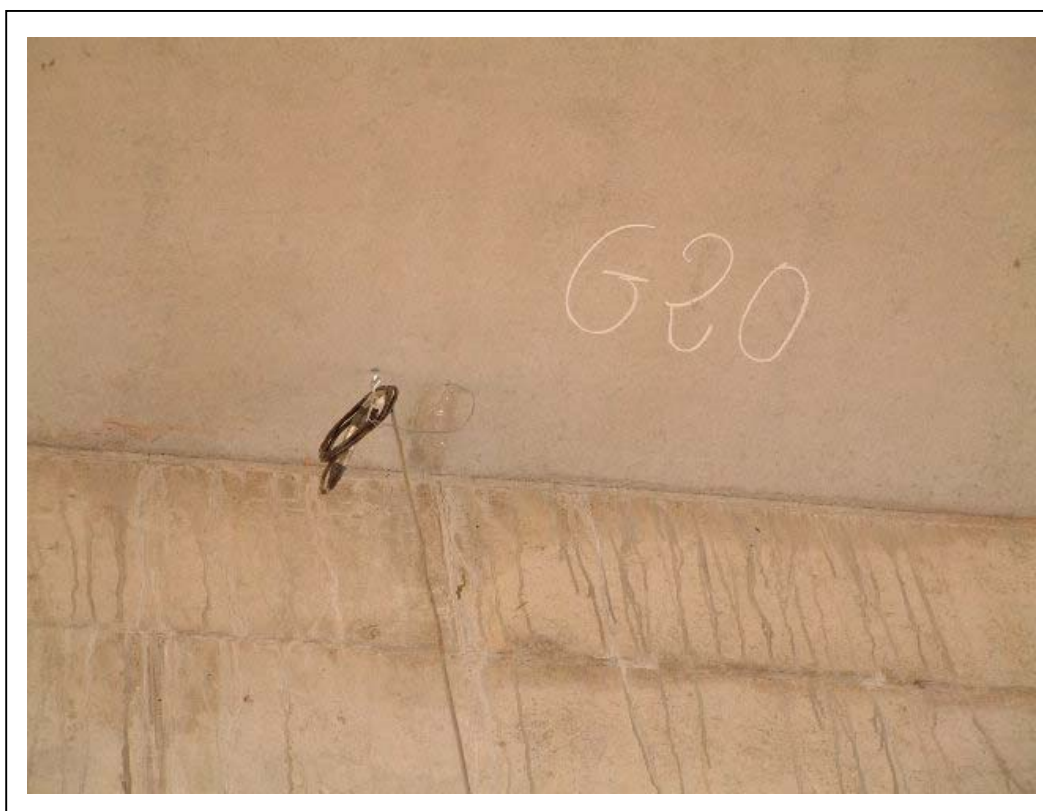
FOTOGRAFÍA 8: Galga instrumentada junto a estribo Zaragoza
