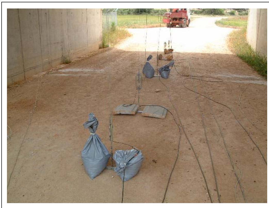
FOTOGRAFÍA 9: Transductores de desplazamiento anclados al suelo para la medida de flechas
