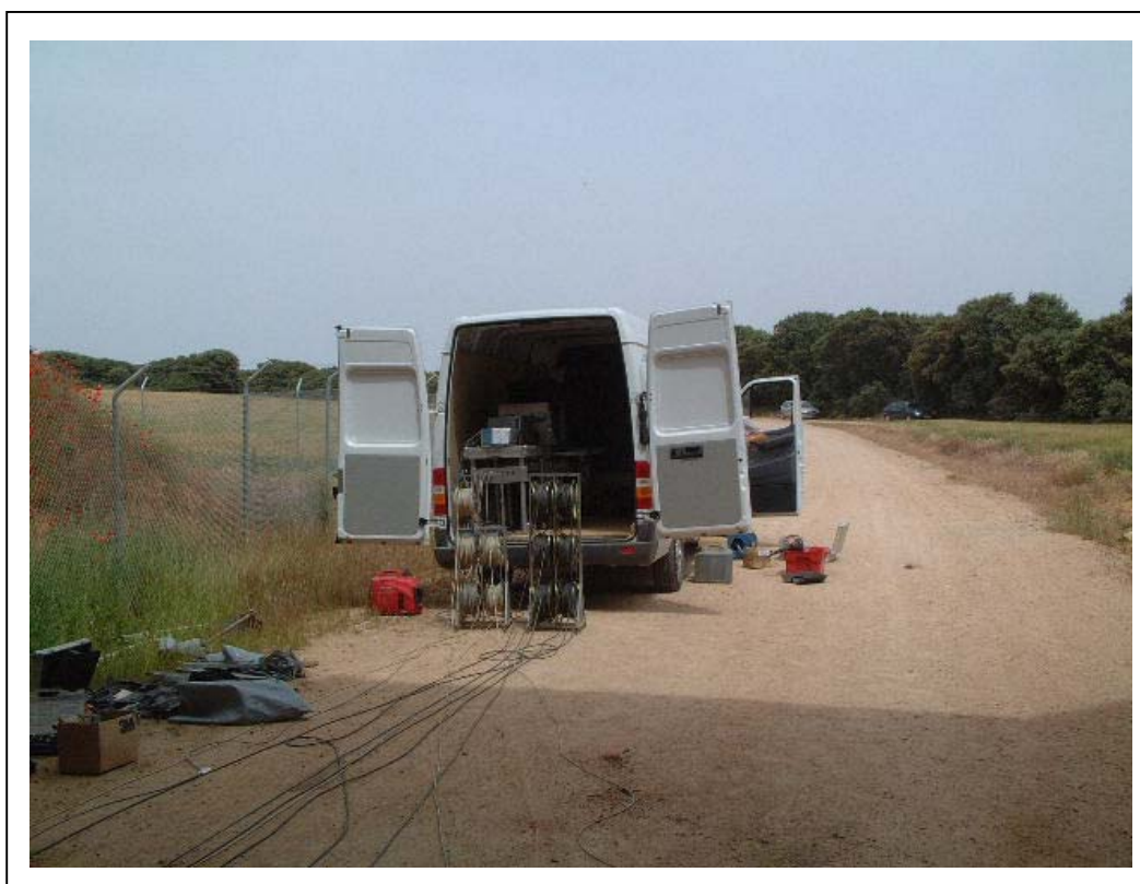
FOTOGRAFÍA 4: Laboratorio móvil y bobinas de medida
