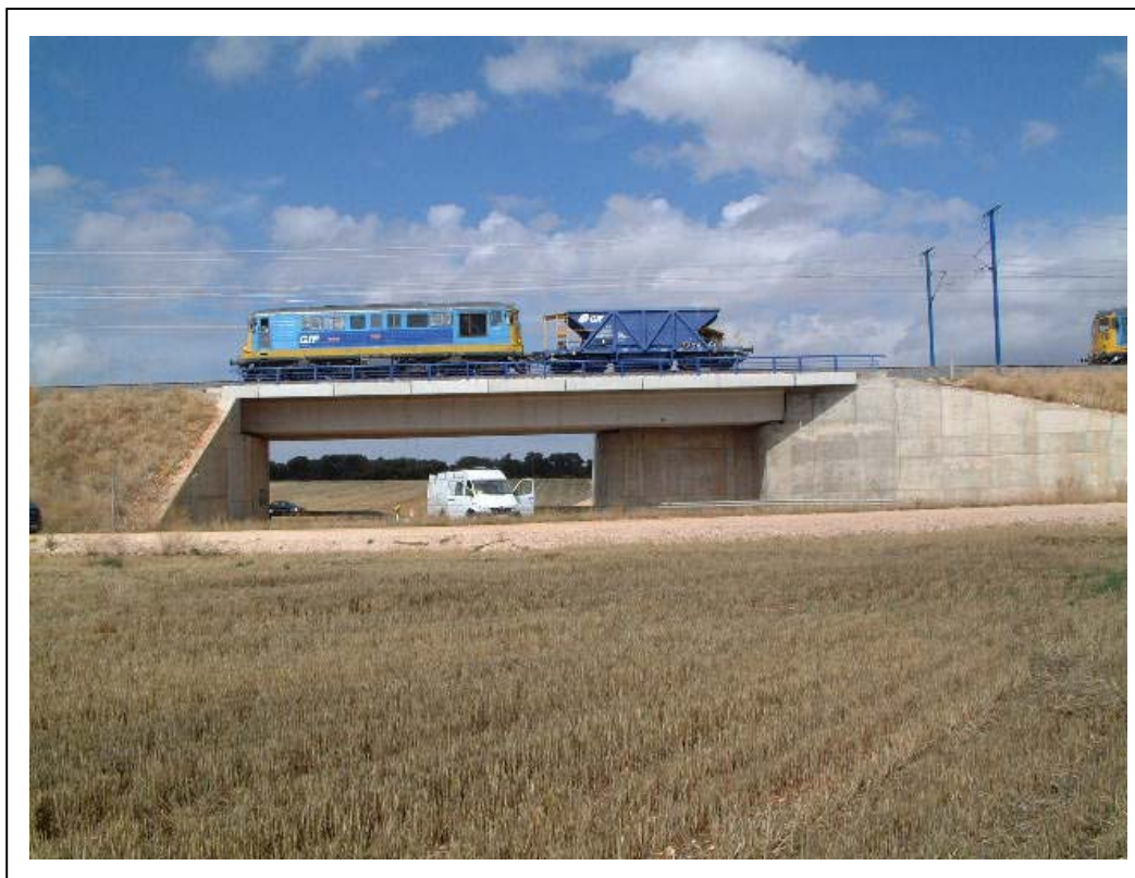
FOTOGRAFÍA 9: Trenes de carga posicionándose para la prueba estática (vista lateral derecha)
