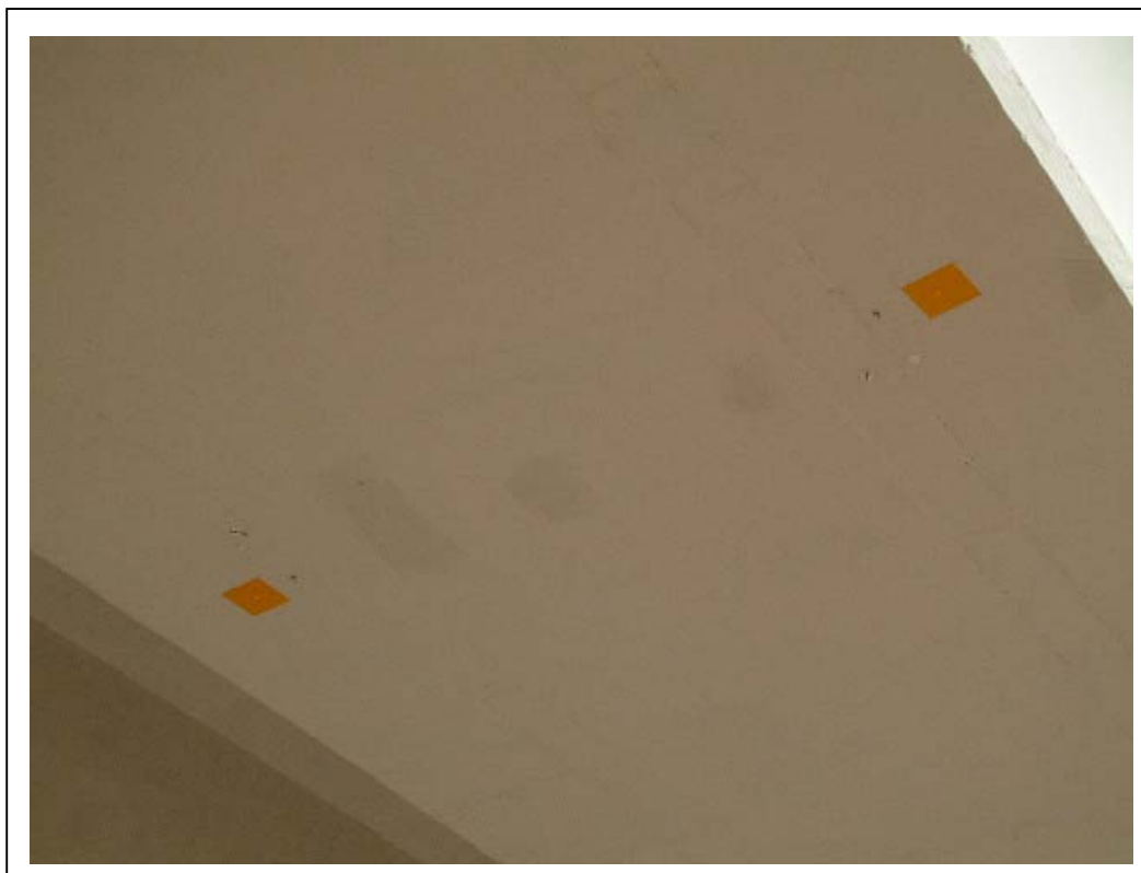
FOTOGRAFÍA 5: Adhesivos para lectura de flechas con láser
