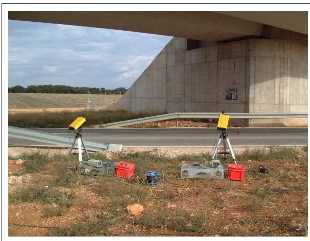
FOTOGRAFÍA 4: Aparatos láser para la medida de flechas
