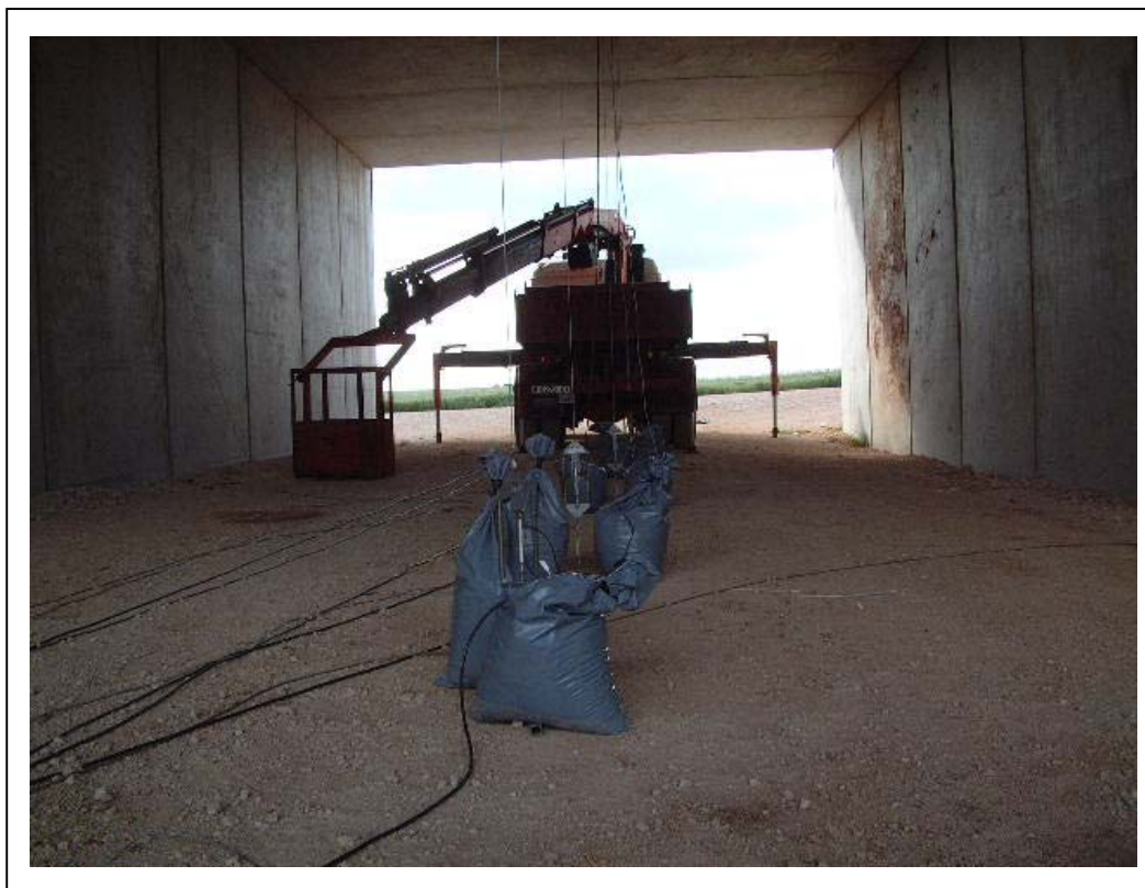
FOTOGRAFÍA 9: Transductores de desplazamiento fijados al suelo y maquinaria auxiliar para la instrumentación del P.I.
