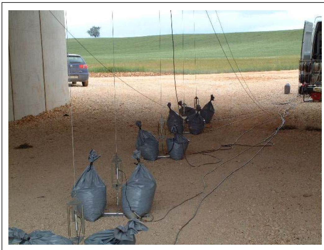
FOTOGRAFÍA 9: Transductores de desplazamiento anclados al suelo y cables de conexión unidos al laboratorio móvil
