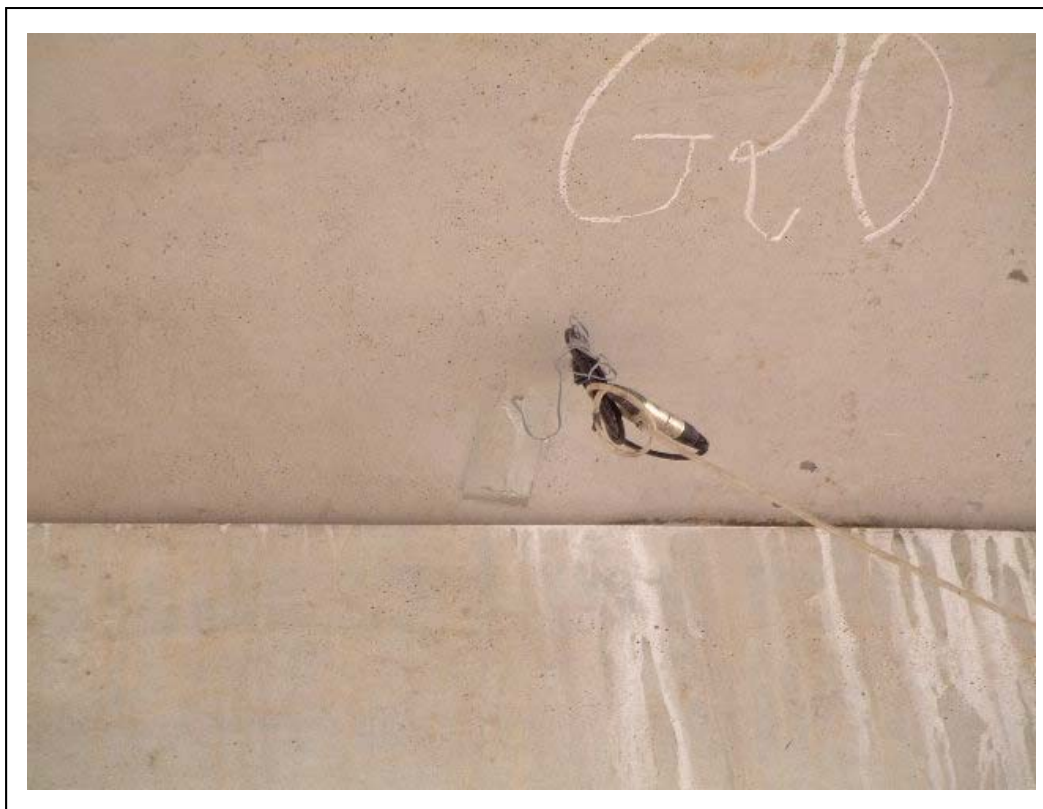
FOTOGRAFÍA 7: Galga extensométrica junto a estribo Madrid
