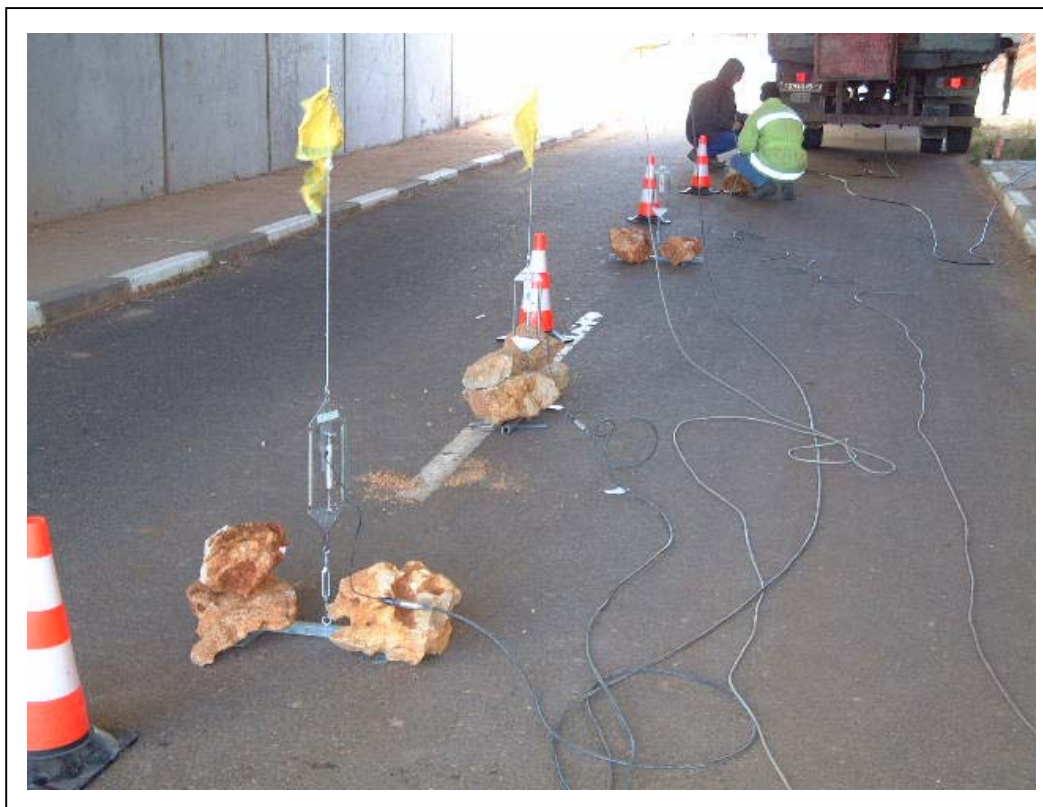
FOTOGRAFÍA 11: Transductores para la medida de desplazamientos anclados al suelo
