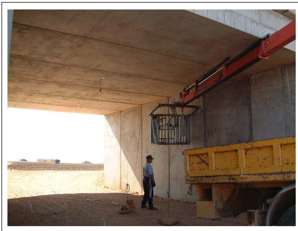
FOTOGRAFÍA 3: Medios auxiliares para la instrumentación del Paso Inferior (grúa con cesta)
