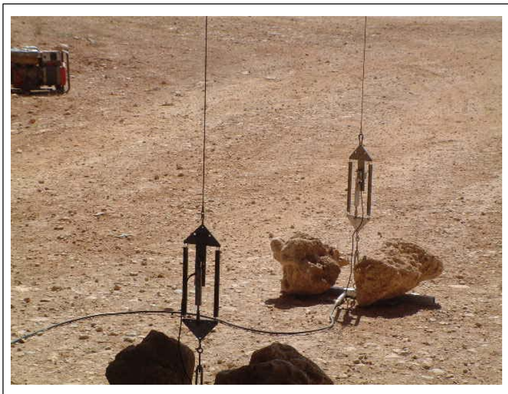
FOTOGRAFÍA 9: Puntos para la medida de desplazamientos verticales del tablero fijados al suelo
