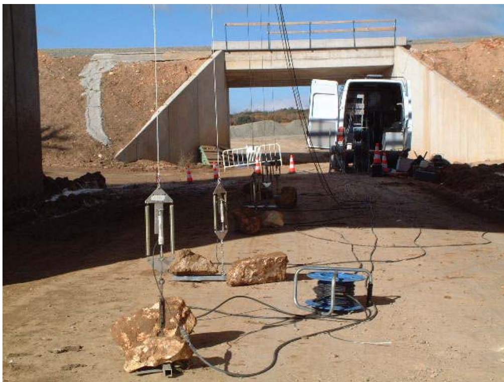
FOTOGRAFÍA 8: Transductores de desplazamiento para medida de desplazamientos verticales en centro de vano anclados al suelo
