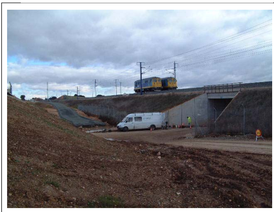
FOTOGRAFÍA 9: Tren de carga tipo circulando por vía 1 para la realización de uno de los ensayos dinámicos
