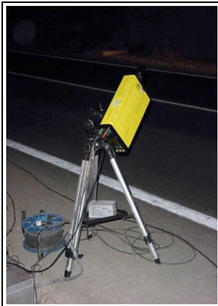
Foto 7: Dispositivo óptico láser para la medida de desplazamientos
