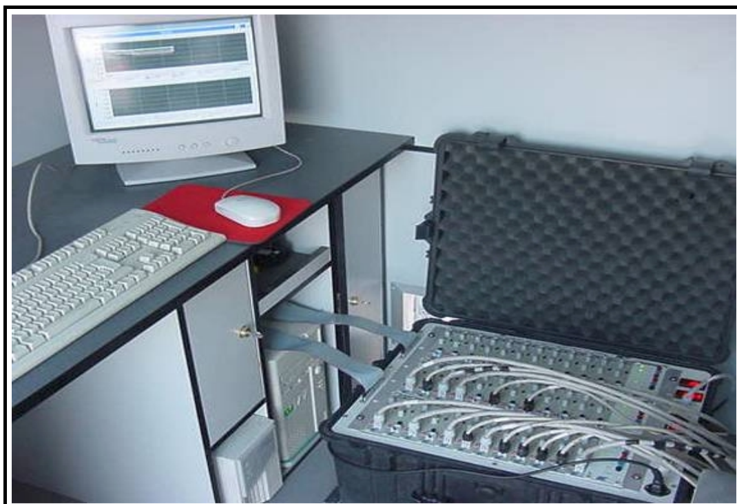
Foto 11: Vista general de acondicionadores de señal y equipo de adquisición
