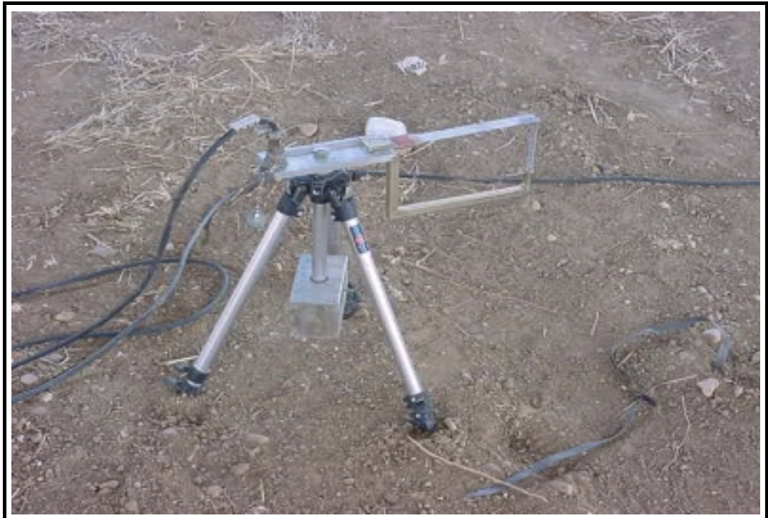
Foto 5: Detalle de ménsula para la medida de desplazamientos
