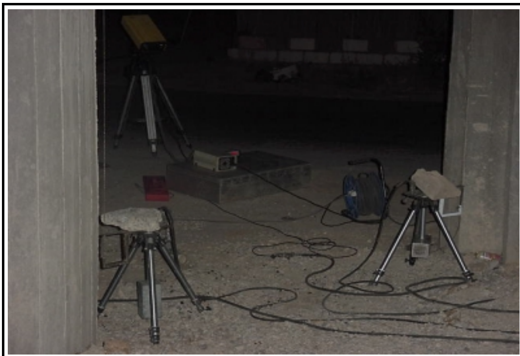
Foto 6: Ménsulas para la medida de desplazamientos
