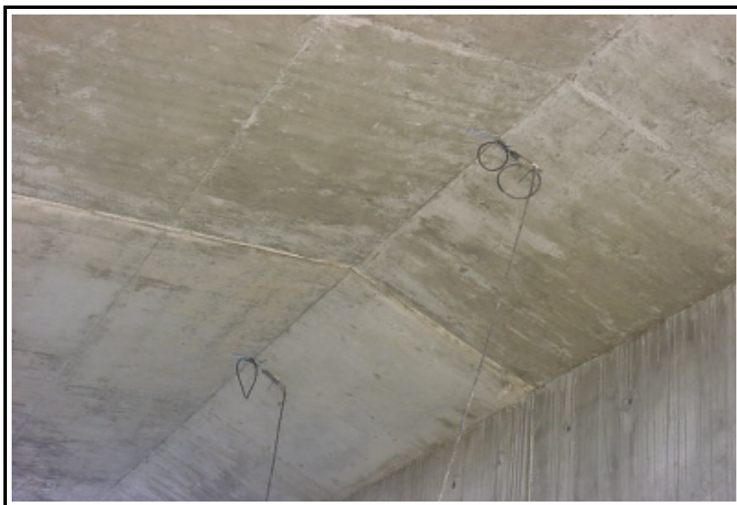
Foto 6: Detalle de bandas extensométricas para la medida de bandas extensométricas
