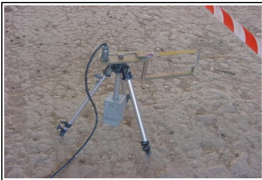
Foto 5: Detalle de ménsula para medida de desplazamientos
