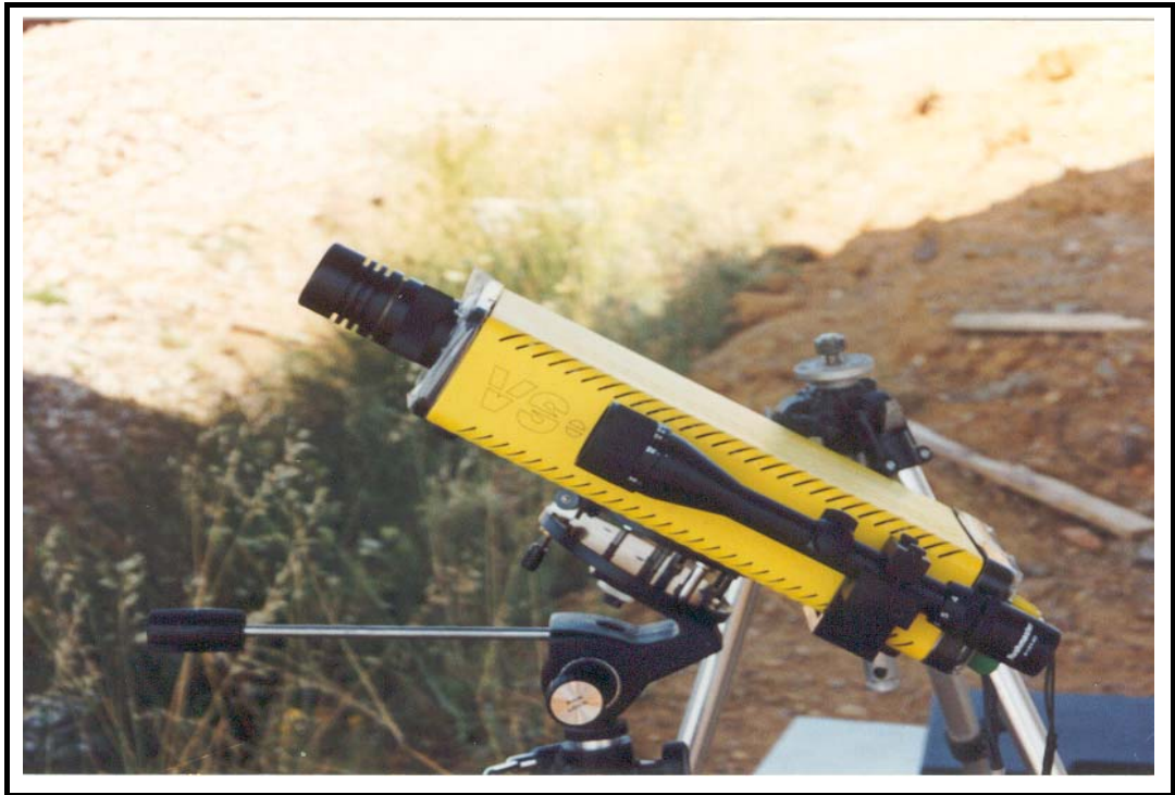
Foto 7: Sensor óptico láser para la medida de flecha
