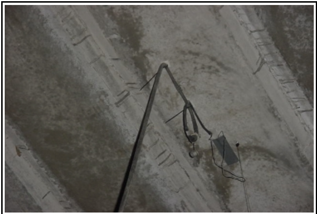
Foto 8: Detalle de banda extensométrica para la medida de deformaciones unitarias
