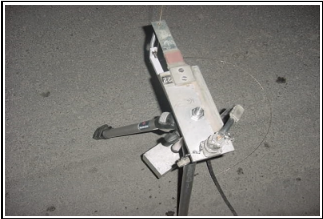
Foto 7: Detalle de ménsula para la medida de desplazamientos
