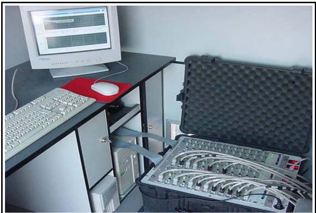
Foto 10: Vista general de acondicionadores y equipo de adquisición
