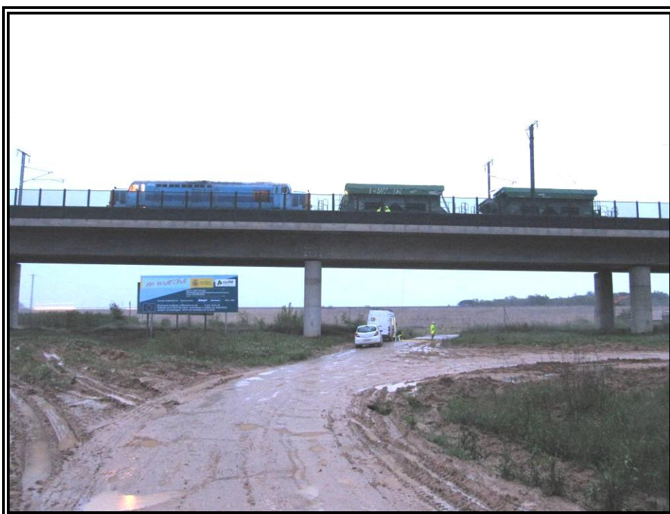
Nº 14.- Prueba estática Estado Nº 3 (Carga en vanos Nº 2 y Nº 3).
