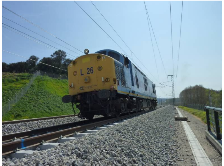
Fotografía N°10: Ensayo dinámico a 80 km/h.
