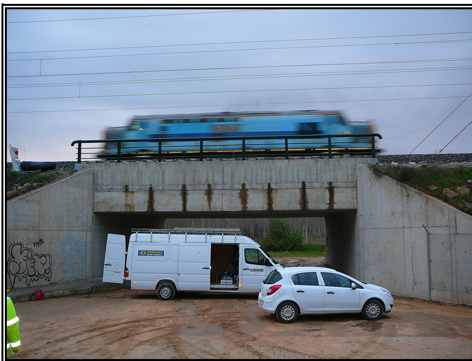
Nº 7.- Realización de prueba dinámica a 30km/h.
