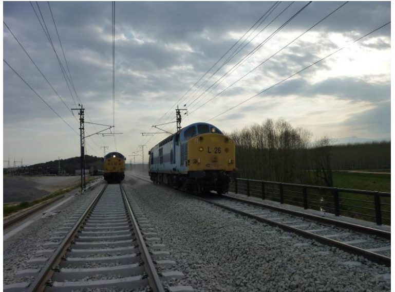
Fotografía N°10: Ensayo dinámico a 75 km/h.
