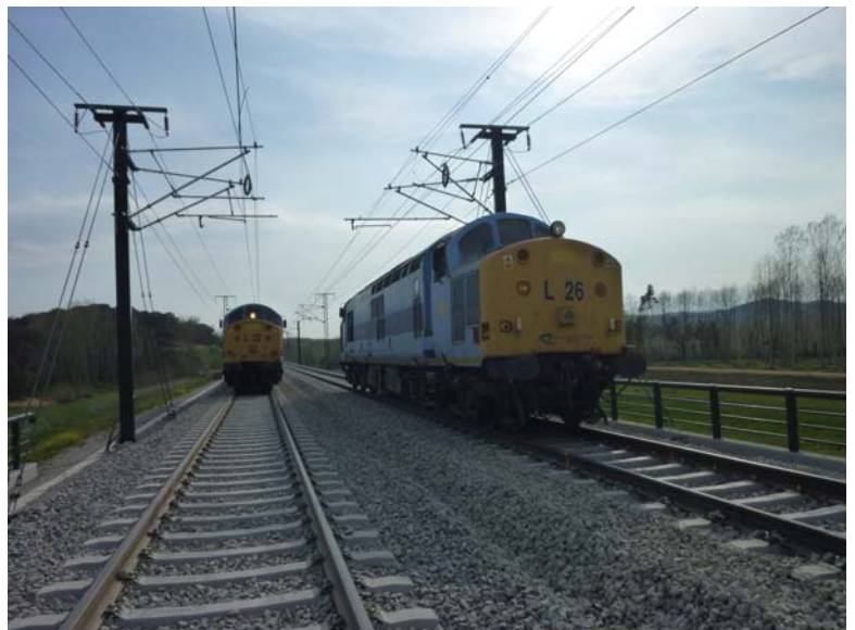
Fotografía N°6: Ensayo dinámico a 30 km/h.
