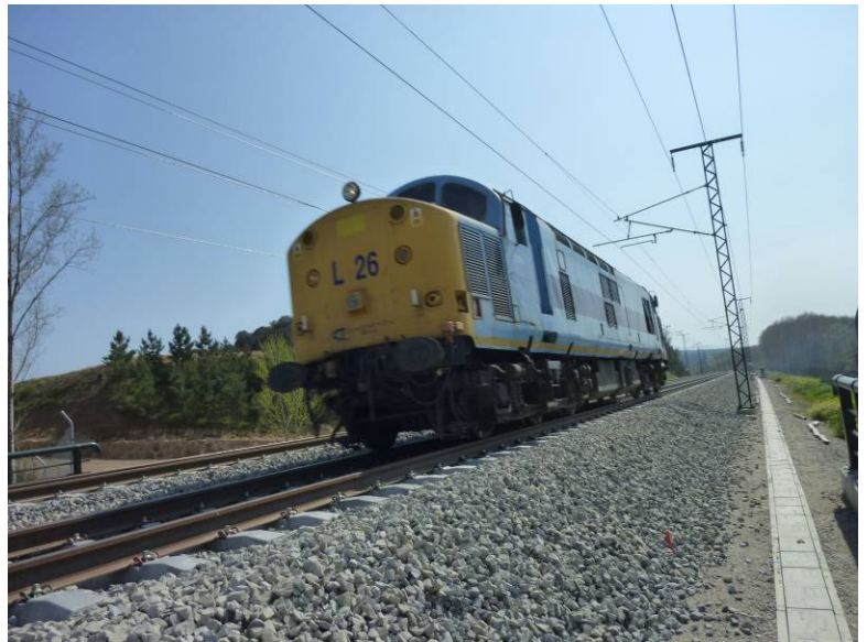
Fotografía N°7: Ensayo dinámico a 30 km/h.
