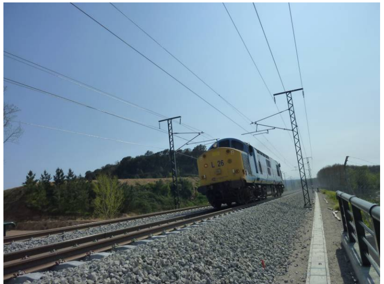
Fotografía N°8: Ensayo dinámico a 80 km/h.
