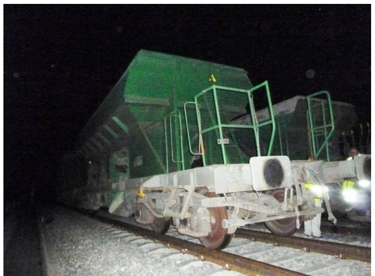
Fotografía N°21: Detalle de las tolvas empleadas durante los ensayos estáticos.
