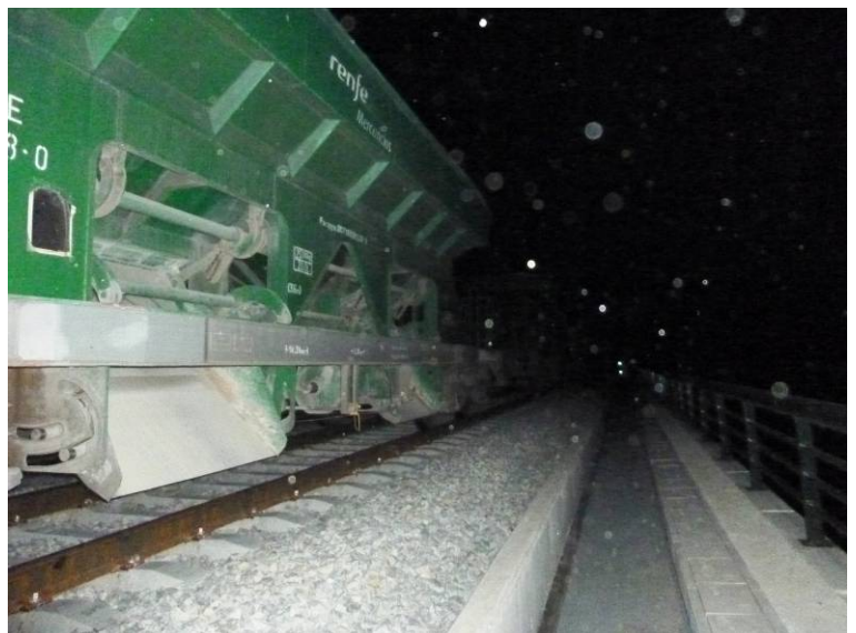
Fotografía N°20: Detalle de las tolvas empleadas durante los ensayos estáticos.
