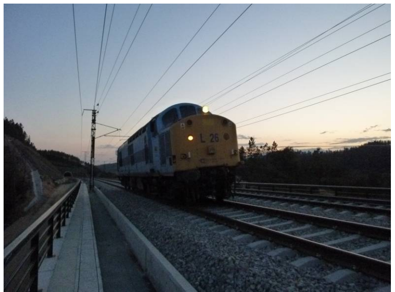
Fotografía N°17: Ensayo de frenado en vano 2.
