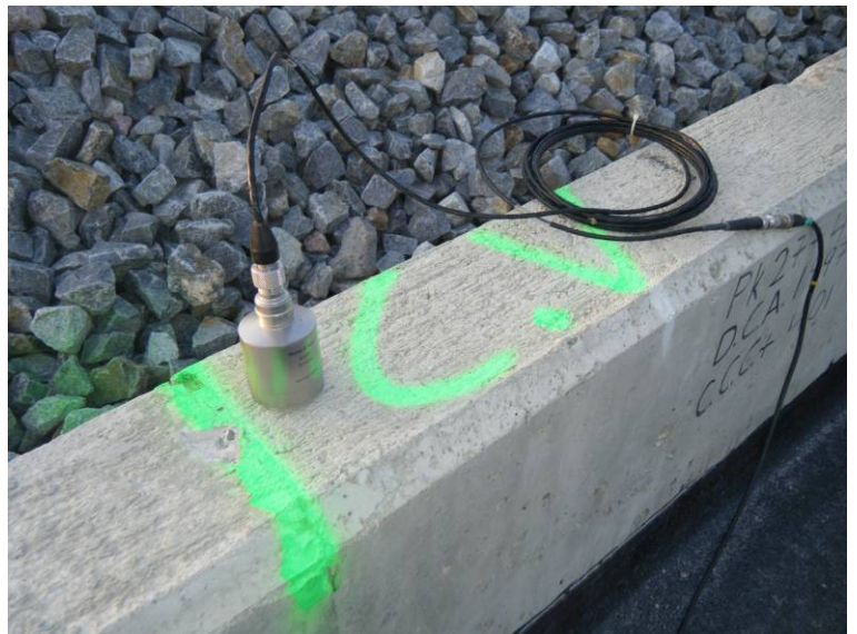
Fotografía N°4: Acelerómetro Brüel & Kjaer.
