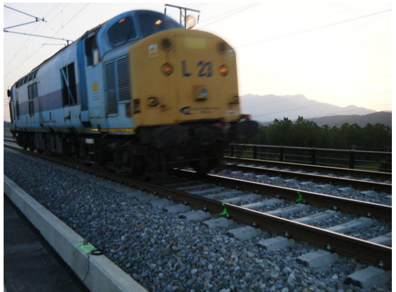
Fotografía N°20: Detalle de la locomotora durante el ensayo dinámico de frenado.
