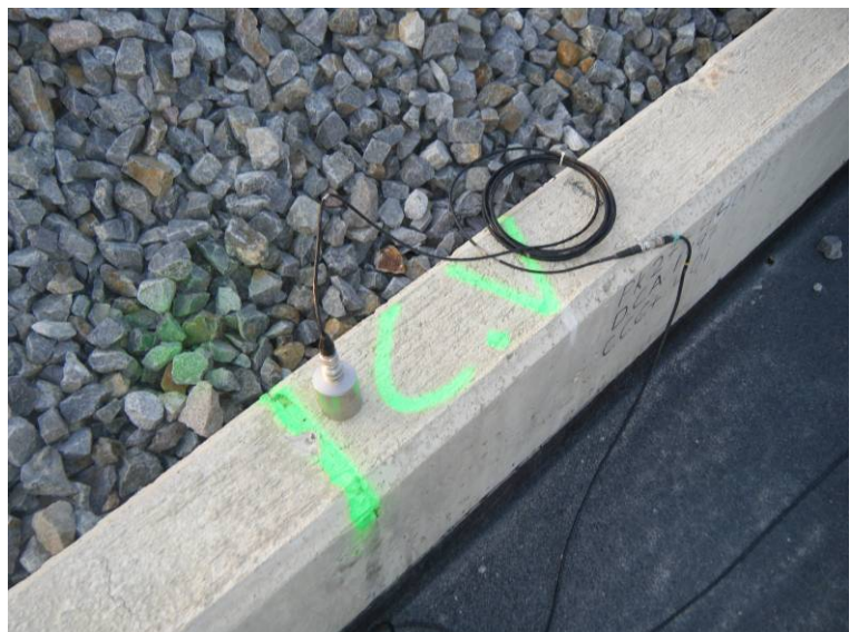
Fotografía N°3: Acelerómetro Brüel & Kjaer.
