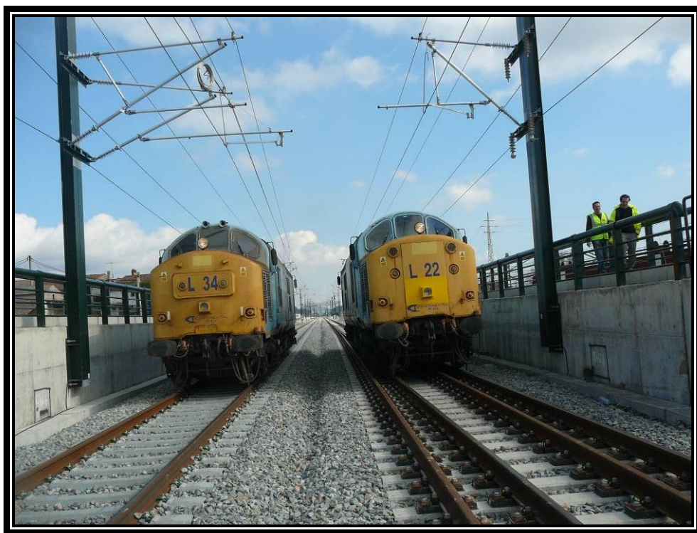
Nº 4.- Realización de prueba estática.
