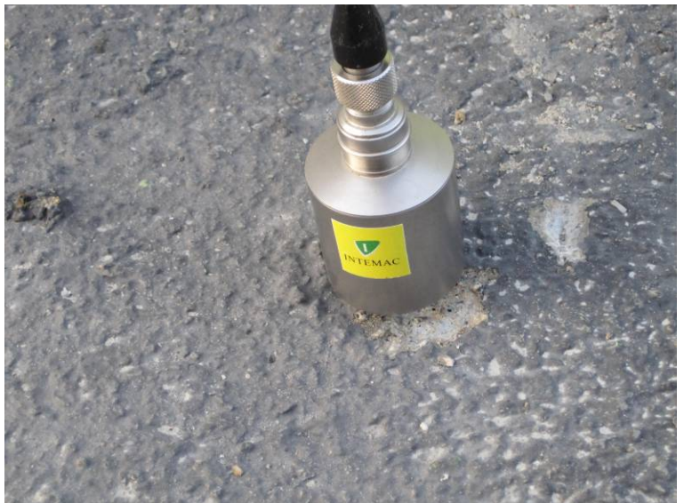
Fotografía N°9: Acelerómetro empleado en la prueba
