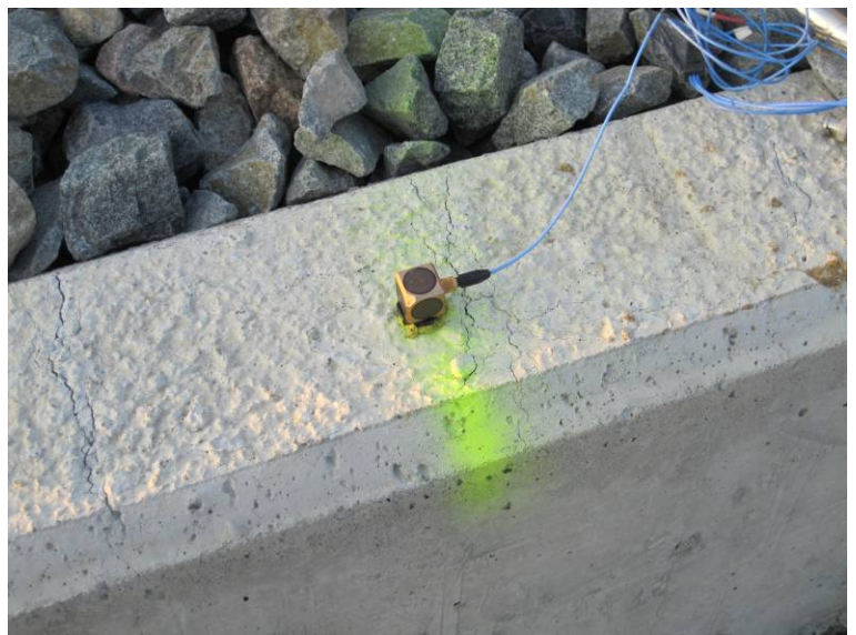
Fotografía N°11: Acelerómetro triaxial empleado en la prueba
