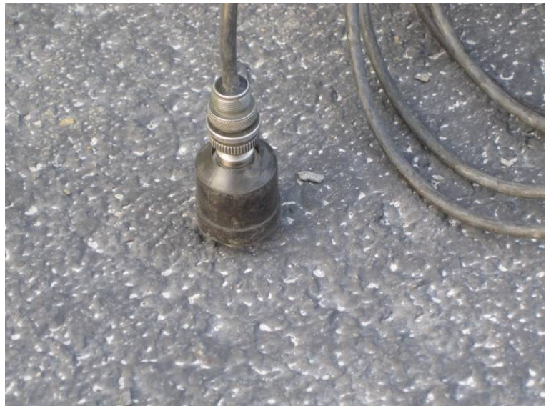
Fotografía N°10: Acelerómetro empleado en la prueba
