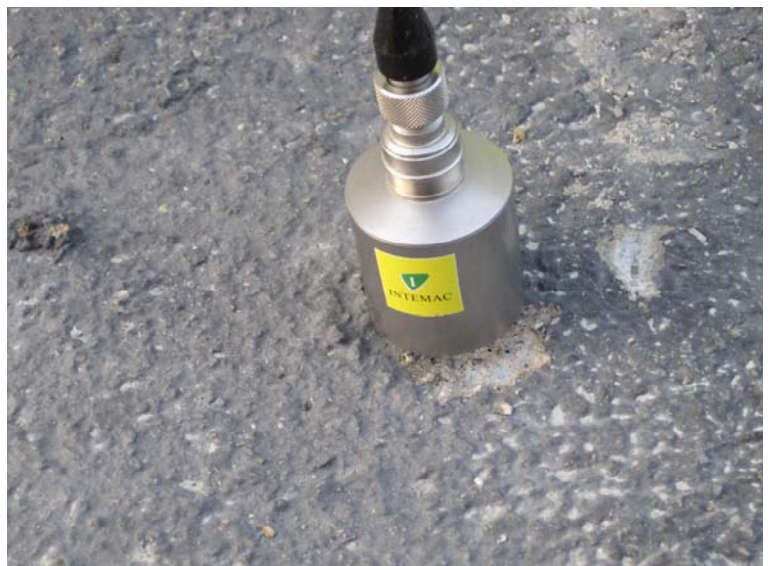
Fotografía N°18: Acelerómetro empleado en la prueba
