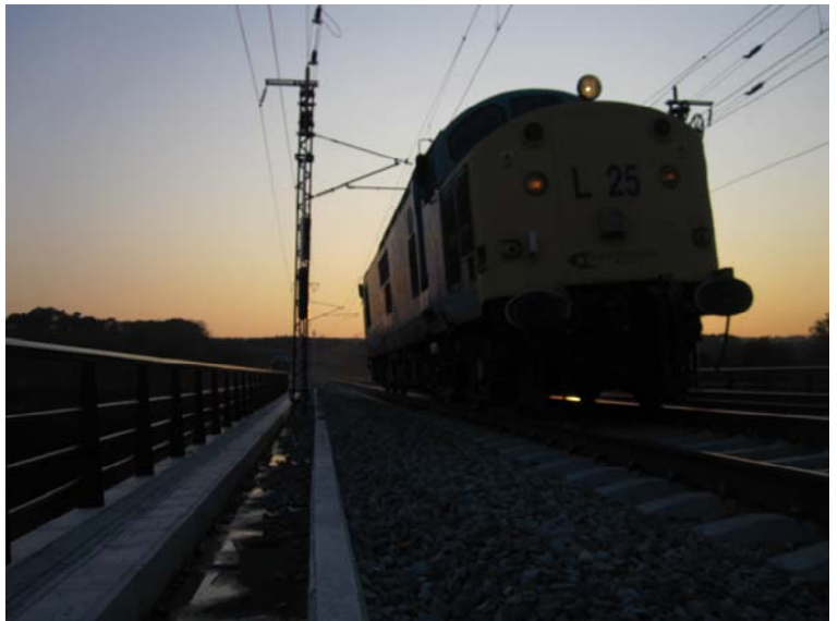
Fotografía N°7: Ensayo de frenado vano 2
