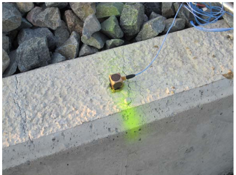
Fotografía N°20: Acelerómetro triaxial empleado en la prueba
