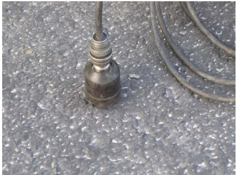
Fotografía N°19: Acelerómetro empleado en la prueba
