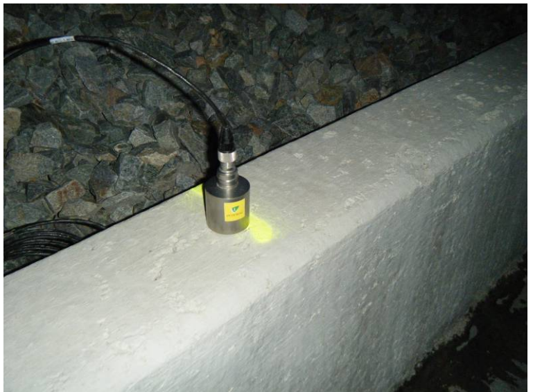
Fotografía N°12: Acelerómetro empleado en la prueba
